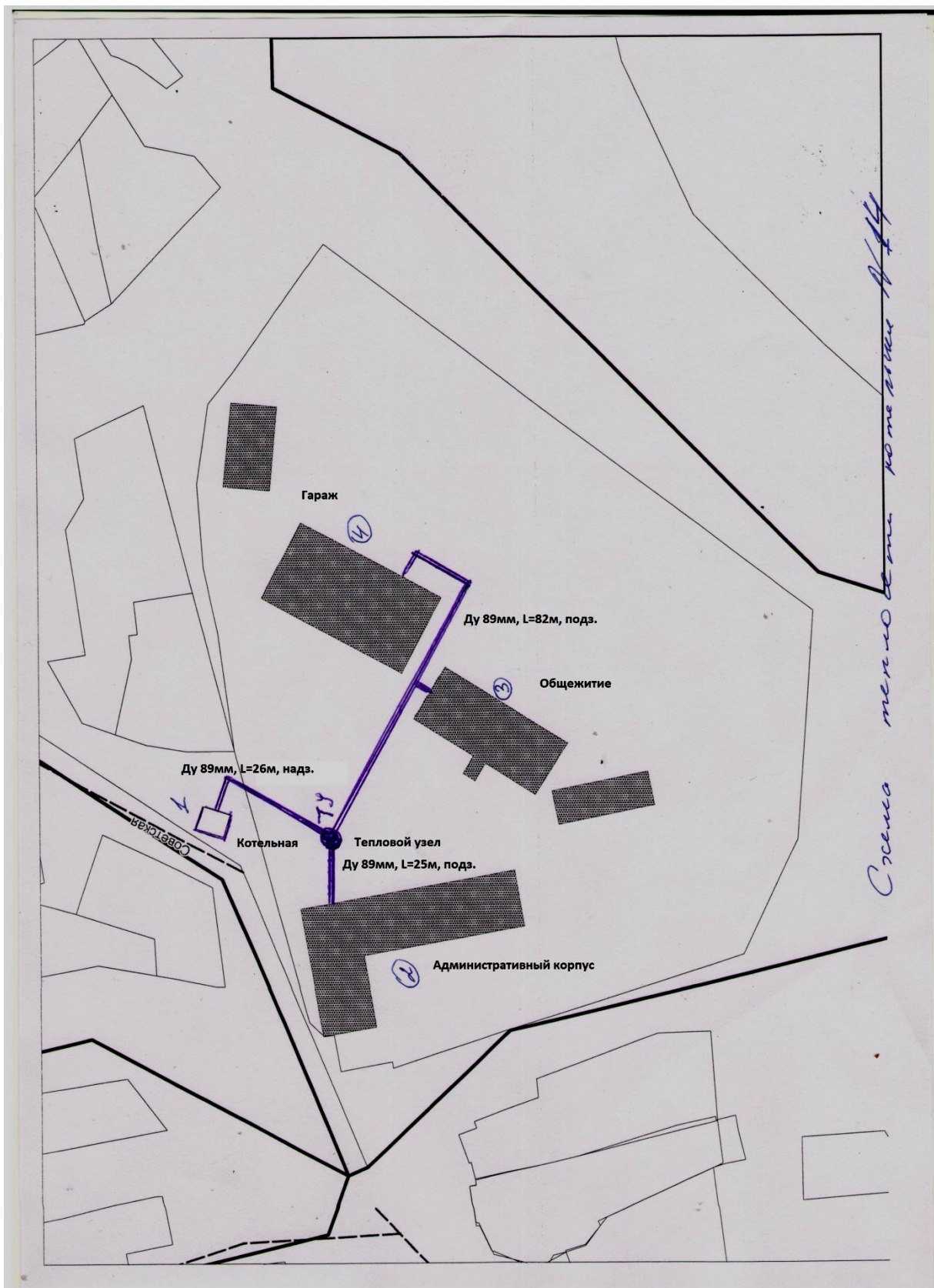
Рисунок 21. Схемы тепловых сетей от котельной №14 на территории с. Богатое
